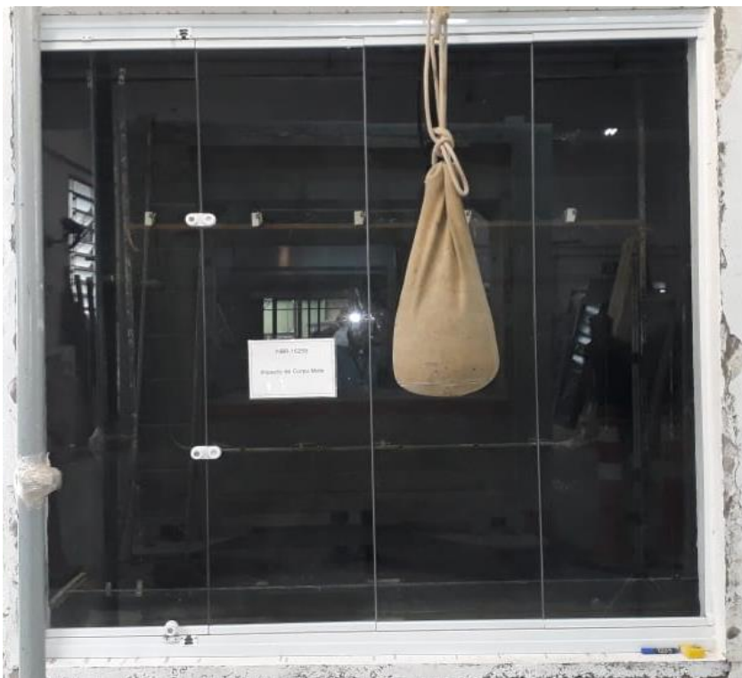
Foto 02 – Visualização do ensaio de impacto de corpo mole.
